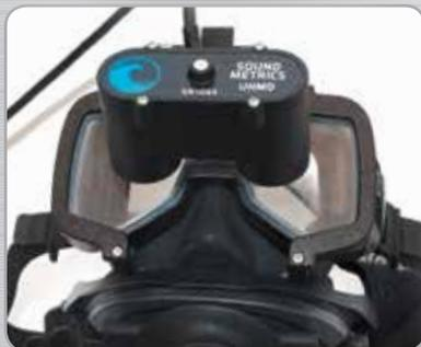
*The Underwater Head Mounted Display (UHMD), fornece detalhes para a localização e identificação de alvos, e funciona quando é mais necessário.*
