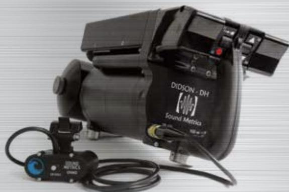
*Manipulado pelo mergulhador, o sonar de alta definição e frequência dual autônoma com UHMD permite que um mergulhador trabalhe em condições de visibilidade zero*
